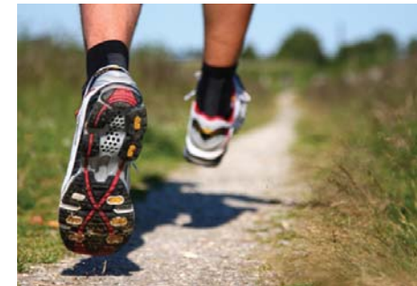
그림 SBR(=블록 공중합체)는 신발 밑창이나 타이어의 노면 접합부 같은 내구성이 필요한 단단한 고무에 사용됨
