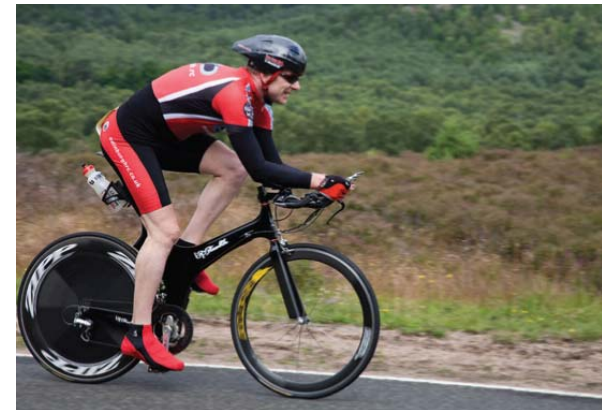
그림 탄소섬유와 에폭시를 이용한 복합 재료로 매우 강하고 가벼운 자전거 본체 (약 1kg)를 만들 수 있게 되었음
