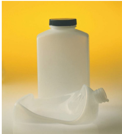
그림 10.2 모두 폴리에틸렌으로 만들어진 2개의 병을 같은 오븐에서 같은 시간 가열하였다.
