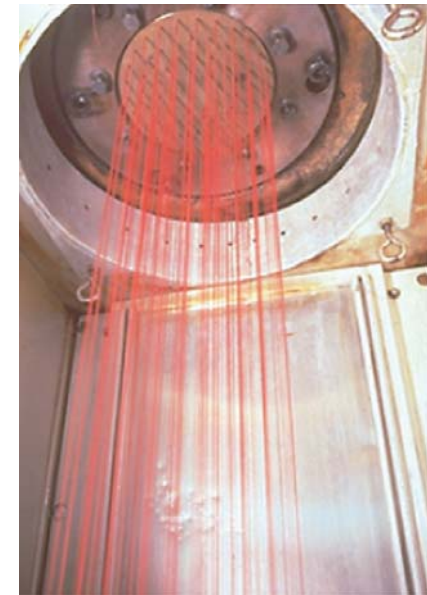
그림 방적기로부터 나오는 섬유. 녹은 고분자를 작은 구멍으로 밀어내어 섬유를 만든다. 온도가 내려가면 고체가 된다.
