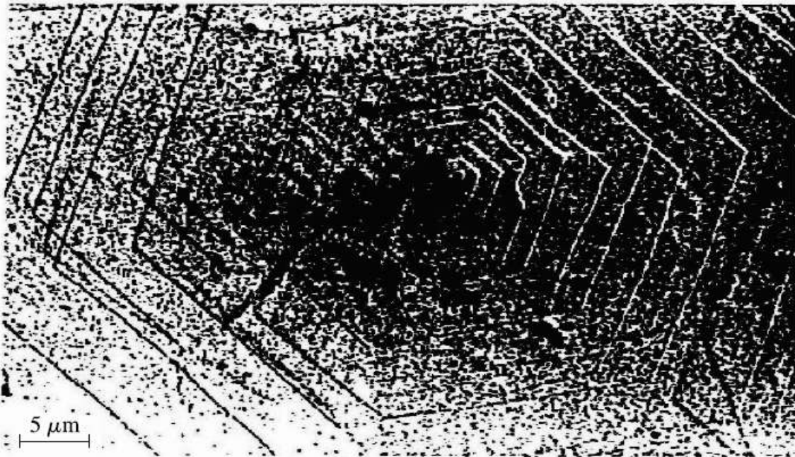
그림 6-6 나선형의 연속층 형상을 보여주는 polyethylene 다층 결정의 현미경 사진
