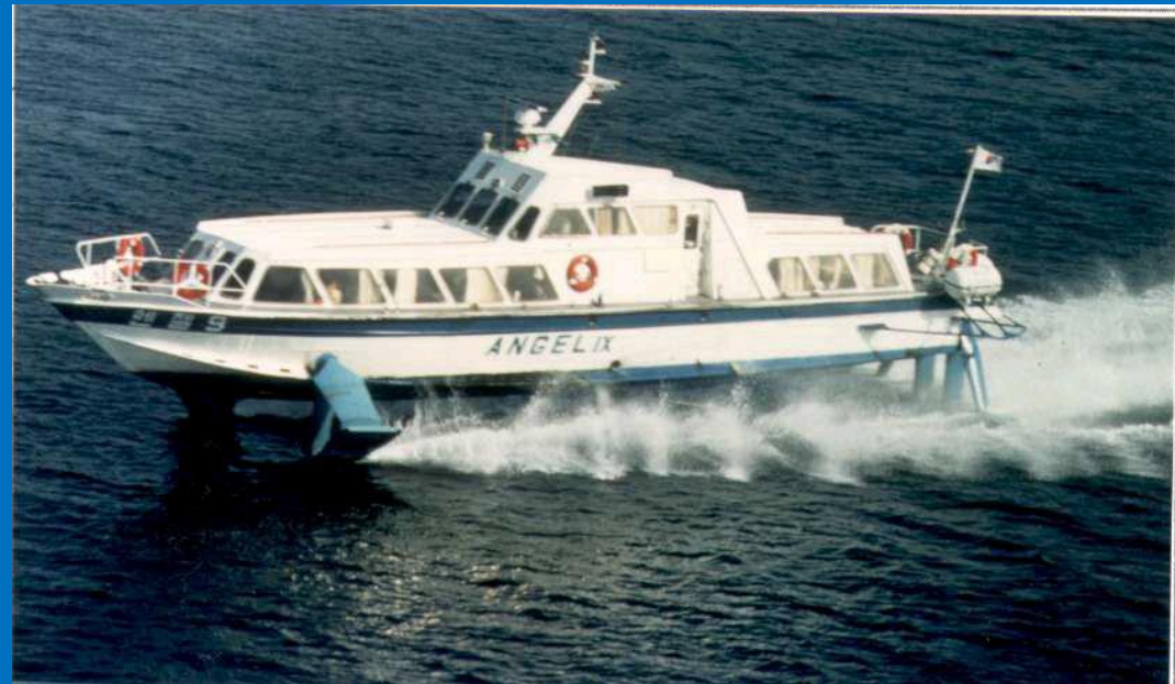
현대중공업에서 1985년 건조한 엔젤 9호 (전장 21m, 배수량 40톤 72인승, 선속 36노트)
