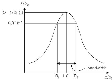
증폭률이  $\frac{Q}{\sqrt{2}}$ 로 떨어지는 점을  $R_1, R_2$ 을 반동력점(half power points) 이라고 하는데 이는 조화운동을 하는 감쇠기의 동력은  $\Delta W = \pi c \omega X^2$ 이기 때문이다. 반동력 점에 해당하는 진동수  $\omega_1$ 과  $\omega_2$ 를 구하기 위하여
